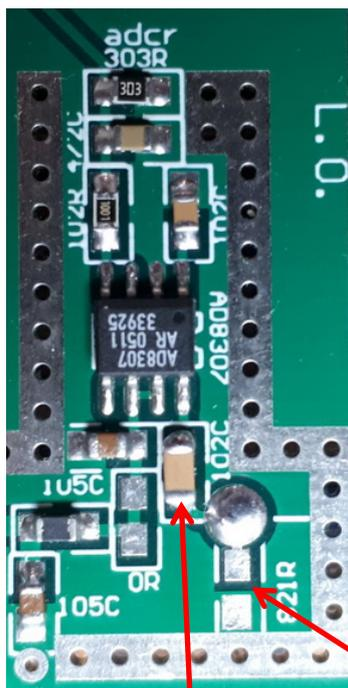
On change la  $1\text{nF}$  par une  $10\text{nF}$  et on **supprime la  $820\Omega$**
