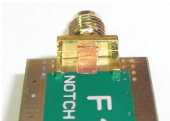
Il existe dans le commerce du clinquant de cuivre avec une face autocollante, ce qui facilite sa mise en place.
