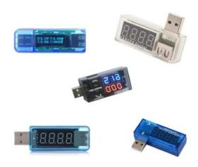
Ce petit module, à l'allure d'une prise USB, permet de connaître alternativement la tension et le courant circulant sur les fils de la prise USB. Branché en série dans la ligne d'alimentation, Il permet, par exemple, d'observer le passage en charge rapide d'un chargeur de téléphone portable : passage de l'état Quick Charge 1 ou QC1 en 5V, vers la charge rapide QC2 en 9V ou QC3 en 12V. Il existe des versions qui affichent simultanément les deux valeurs de tension et de courant.
