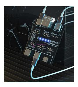
Alimenté en 5 V par un câble USB (connecteur Power In), le module indique la continuité des fils d'un câble à tester branché au module par ses deux extrémités. Le module teste, non seulement les deux fils correspondant à l'alimentation mais aussi les deux fils de données. La continuité est indiquée par l'illumination des diodes LED. Toutes les combinaisons sont possibles en utilisant des adaptateurs.
