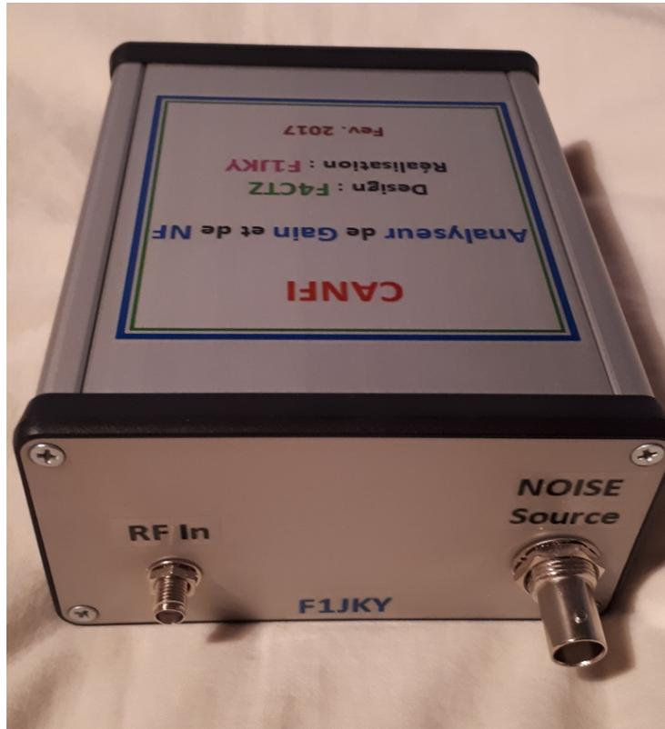
Voici un projet commencé en Nov. 2015 que j'ai enfin finalisé en ce début 2021 grâce à l'aide des copains suite à un regain d'intérêt de quelques personnes de la liste de diffusion HyperFR pour cet appareil de mesure de Gain et de NF (Facteur de Bruit) que je vais principalement utiliser pour la mesure de mes LNA (Low Noise Amplifier aussi appelé « Préampli » par abus de langage chez les HAM).
