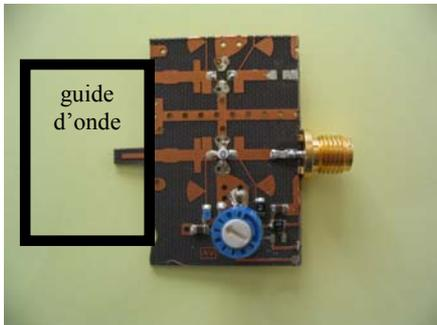
Le circuit N°2 est un peu trop court pour mettre une capa en entrée, il ira très bien pour installer avec la ligne d'entrée directement dans le guide comme prévu à l'origine.
