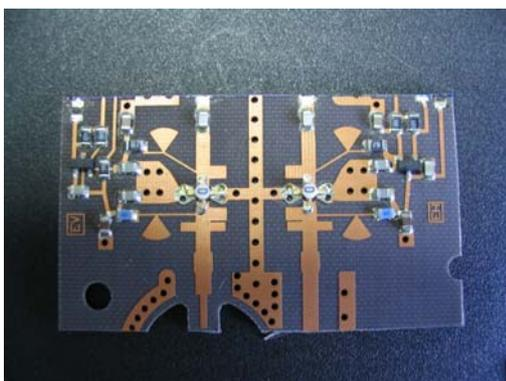
En étant soigneux, on pourrait même récupérer 2 circuits préamplificateurs sur cette platine, mais il faut bien récupérer des transistors (c'était le but initial) et surtout se servir de la capa de sortie de l'un comme capa d'entrée de l'autre.
