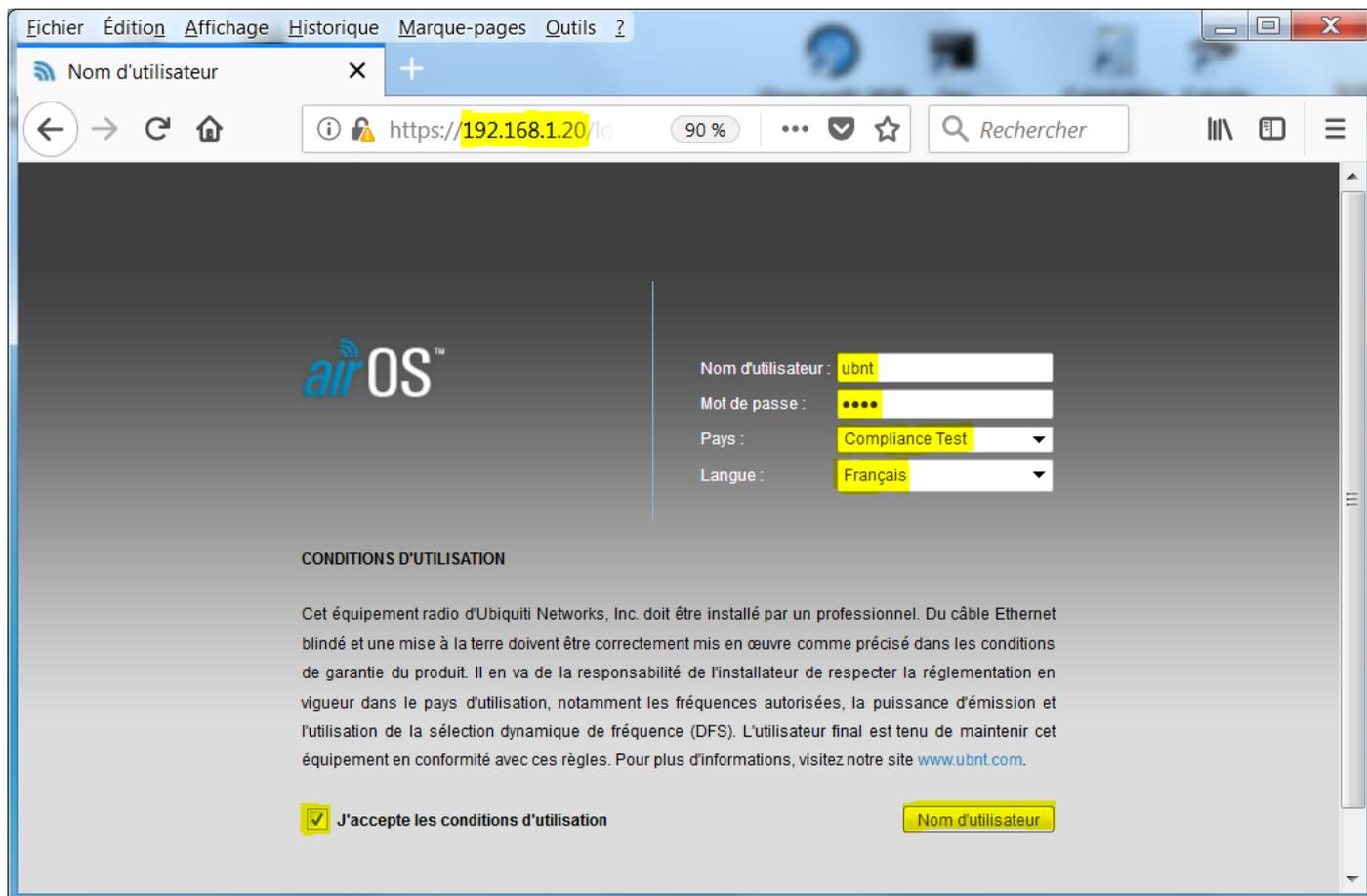
Renseignez les champs comme ci-dessus en choisissant bien le Pays « **Compliance Test** » car c'est ce qui va vous permettre d'accéder aux fréquences Radioamateurs dans la bande 2,3GHz et aussi de vous permettre d'avoir accès au réglage de la puissance RF de votre borne.
