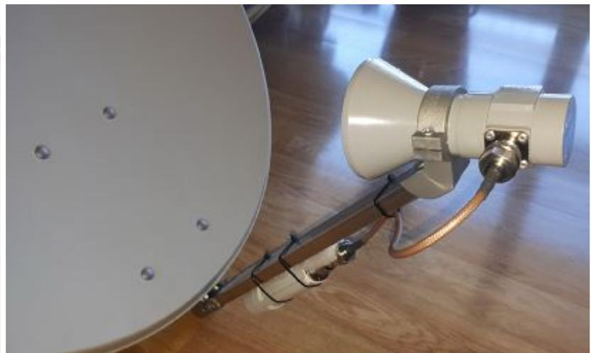
Le Feed (= Tête ou Cornet) 5GHz utilisé pour illuminer cette parabole est un Intfeexx 5X-HV que l'on trouve pour un prix correcte chez [mhzshop.com](http://mhzshop.com) et qui a la particularité de fonctionner très correctement sur la bande Ham. Un PDF dessus ce cornet viendra prochainement et sera déposé sur mon site web : [f1jky.fr](http://f1jky.fr) .
