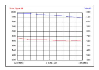
Surprise, la mesure de NF est déplorable. La cause vient de l'utilisation d'une self de polarisation pas adaptée à la fréquence de fonctionnement.
