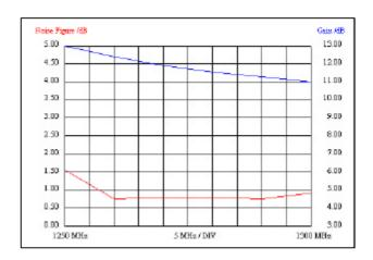
Le bruit mesuré est d'environ 0.75 ou 0.8 dB pour un gain de 11 à 13 dB.
