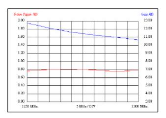
Le bruit mesuré est d'environ 0.75 à 0.8 dB pour un gain de 11 à 13 dB.
